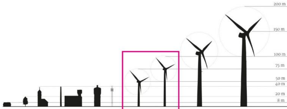
Figuur 3: vergelijking Dorpsmolen met reguliere turbine [4]
